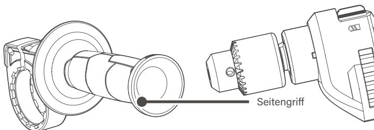
Bitte verwenden Sie stets den Seitengriff, um einen sicheren Betrieb zu gewährleisten. Montieren Sie den Seitengriff auf das Installationsrohr des Werkzeugs.
