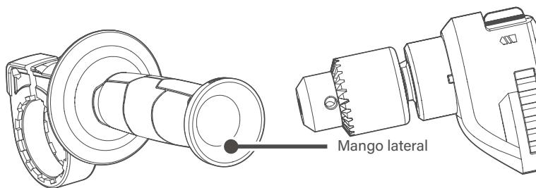
Utilice siempre el mango lateral para garantizar una operación segura. Instale el mango lateral en el tubo de instalación de la herramienta.
