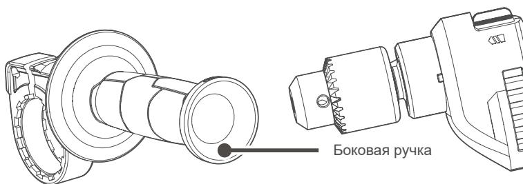
Всегда используйте боковую ручку для обеспечения безопасной работы. Установите боковую ручку на установочную цилиндрическую часть инструмента.
